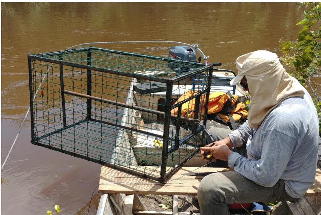
**FIGURA 8:** Gaiolas de metal desenvolvidas para proteção dos sensores de qualidade de água contra impactos mecânicos.
