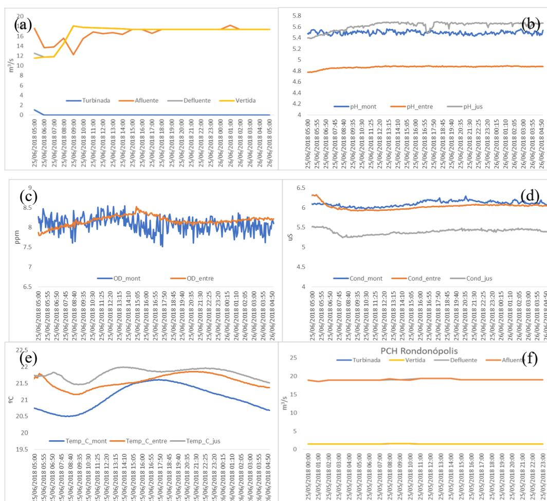
**FIGURA 66:** Leitura de parâmetros em 25/05/2018 em A1. A2 e A3 (a) Vazão PCH<sub>JG</sub>; (b) pH; (c) OD; (d) Condutividade; (e) Temperatura da água; (f) Vazão PCH<sub>Rond</sub>.
