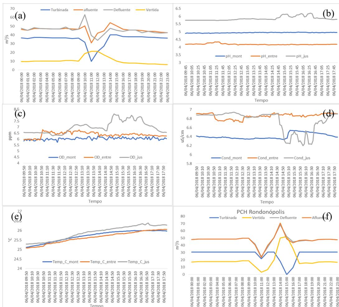
**FIGURA 65:** Leitura de parâmetros em 06/04/2018 em A1, A2 e A3 (a) Vazão PCH<sub>JG</sub>; (b) pH (c) OD (d) Condutividade. (e) Temperatura da água; (f) Vazão PCH<sub>Rond</sub>.
