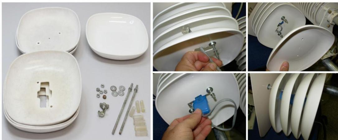
**Figura 8** - Abrigo termométrico com pratos plásticos quadrados de PVC
