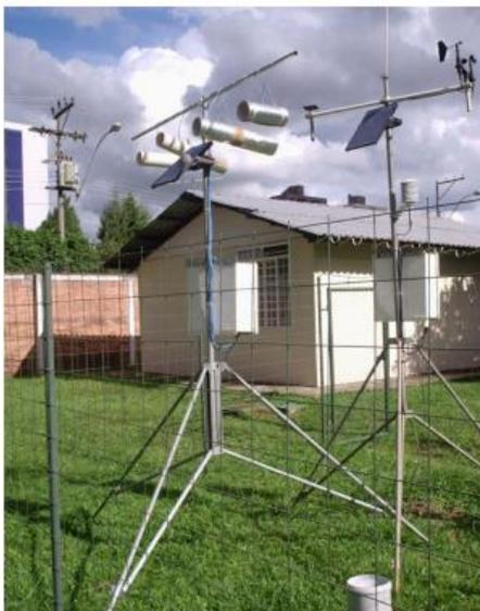
**Figura 13**– Abrigo horizontal para medições fixo - instalados
