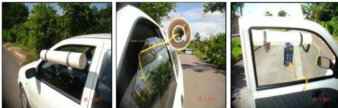
**Figura 10-** Abrigo horizontal em PVC para medições
