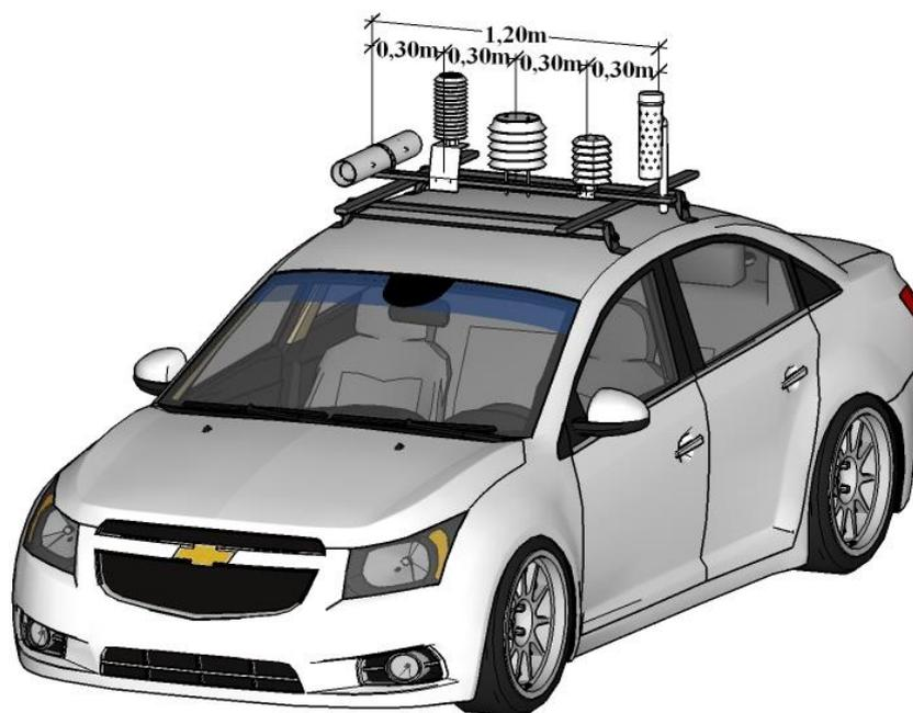
**Figura 34-** Posicionamento dos abrigos no veículo - lateral
