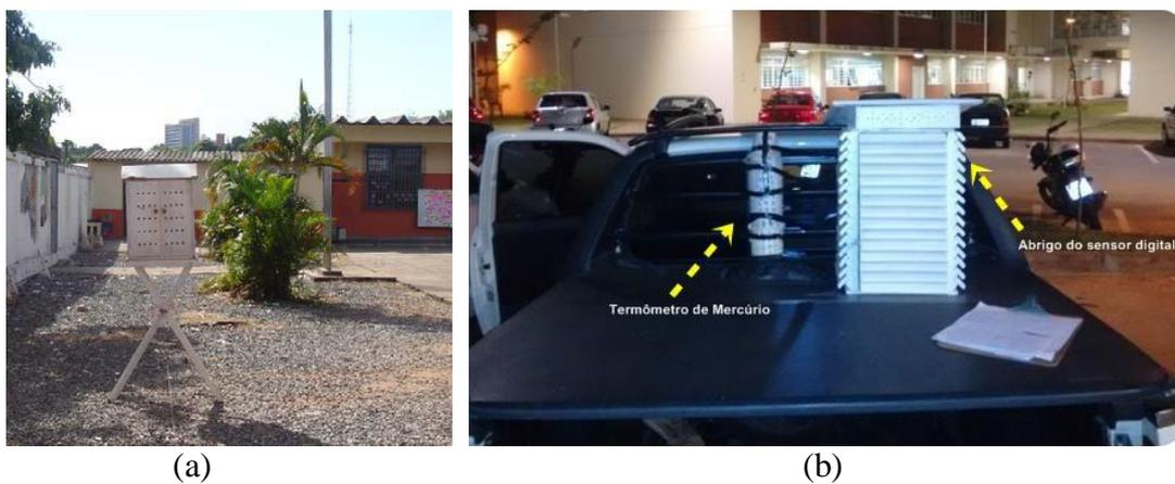
**Figura 18** – Abrigo de madeira: em ponto fixo (a); utilizado em transecto na caçamba de veículo com carroceria (b)
