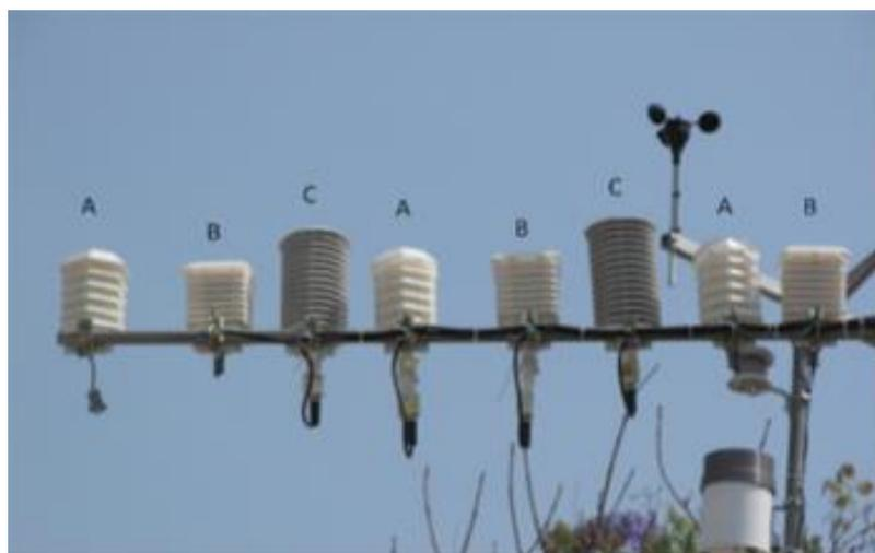
**Figura 3** – Abrigos A e B alternativos fabricados em impressora 3D juntamente com termohigrômetros de referência C, instalados no campo
