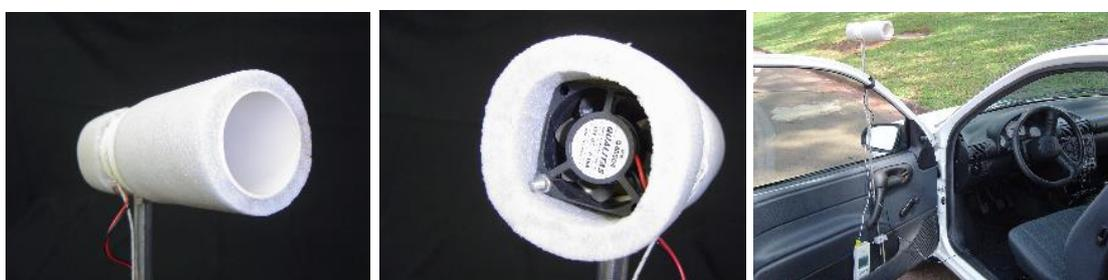
**Figura 11-** Abrigo horizontal em PVC com revestimento e ventilação forçada para medições
