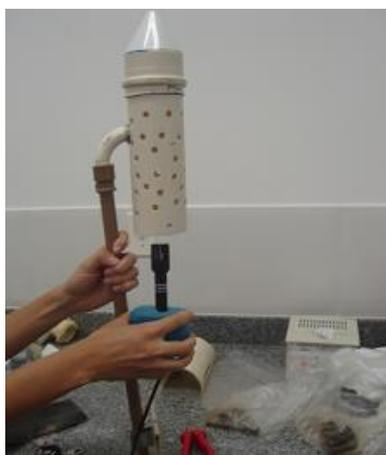
**Figura 1** – Abrigo vertical de PVC para medições
