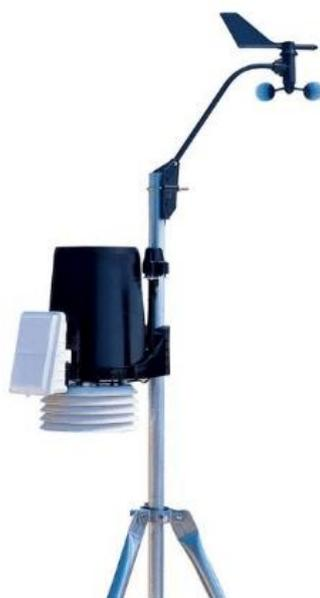
**Figura 61** - Estação automatizada - modelo Vantage Pro 2™
