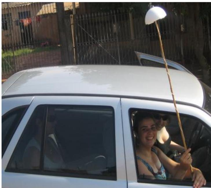
**Figura 15** – Abrigo com semicircunferência de poliestireno com haste de bambu
