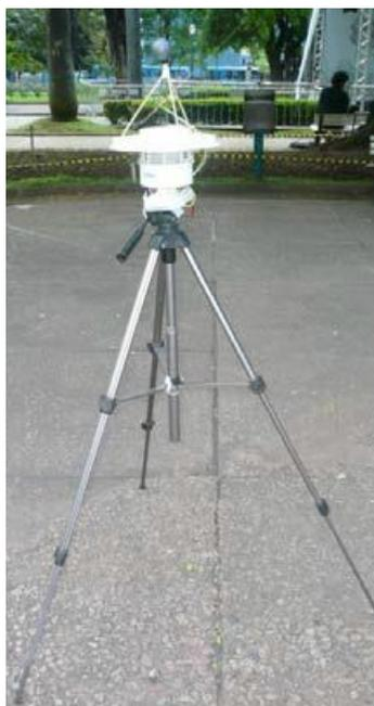
**Figura 16** – Abrigo utilizando peças hidrossanitárias de PVC
