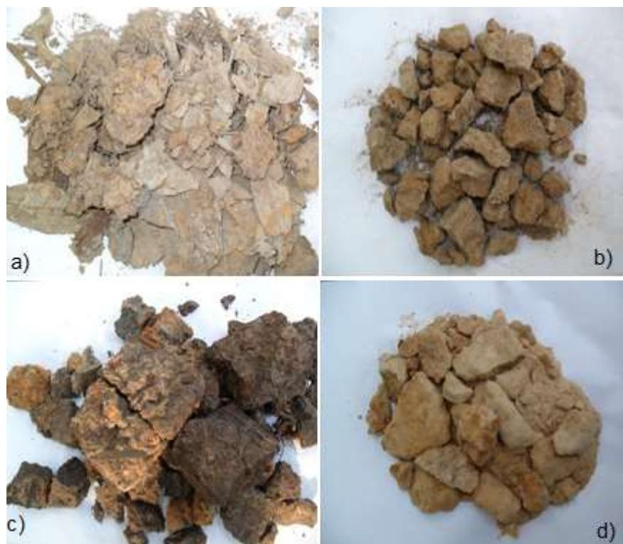
Figura 11 - Trincheira 04 - (a) Grânulos do horizonte A; (b) Grânulos do horizonte B1; (c) Grânulos do horizonte B2; (d) Grânulos do horizonte C.
