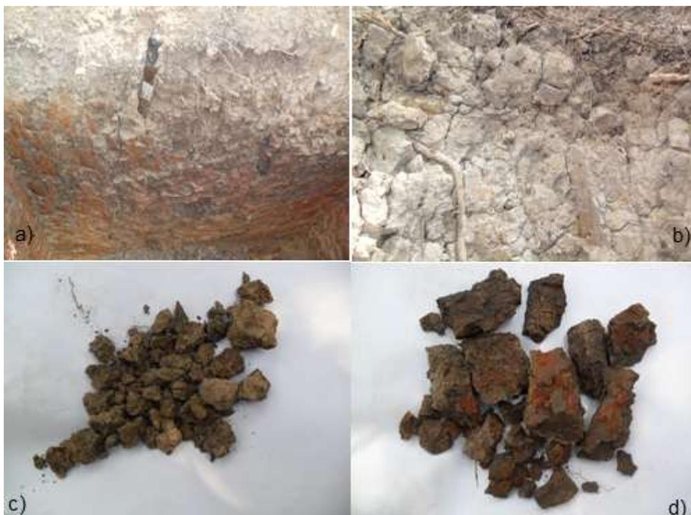
**Figura 9 - (a) Parede da Trincheira 02; (b) horizonte A com a profundidade de 0 a 10; (c) amostra do Horizonte AB com a profundidade de 10 a 30 cm. (d) amostra do Horizonte B que representa a profundidade entre 30 e 170 cm.**
