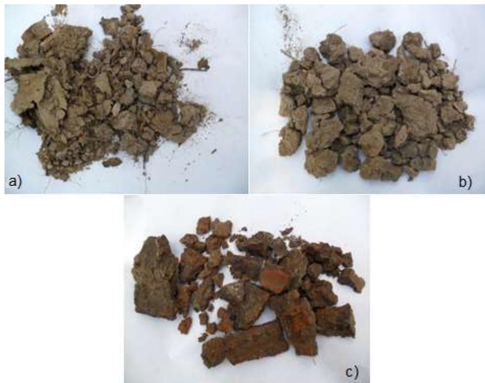
**Figura 10 - Trinchira 03 - (a) Amostra do Horizonte A; (b) Agregado do horizonte AB; (c) Agregado horizonte B.**
