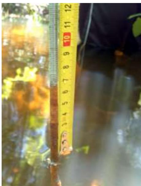
Figura 2: Ponto de amostragem e trena graduada para monitoramento da inundação em área de estudo no Pantanal mato-grossense no ano de 2013.
