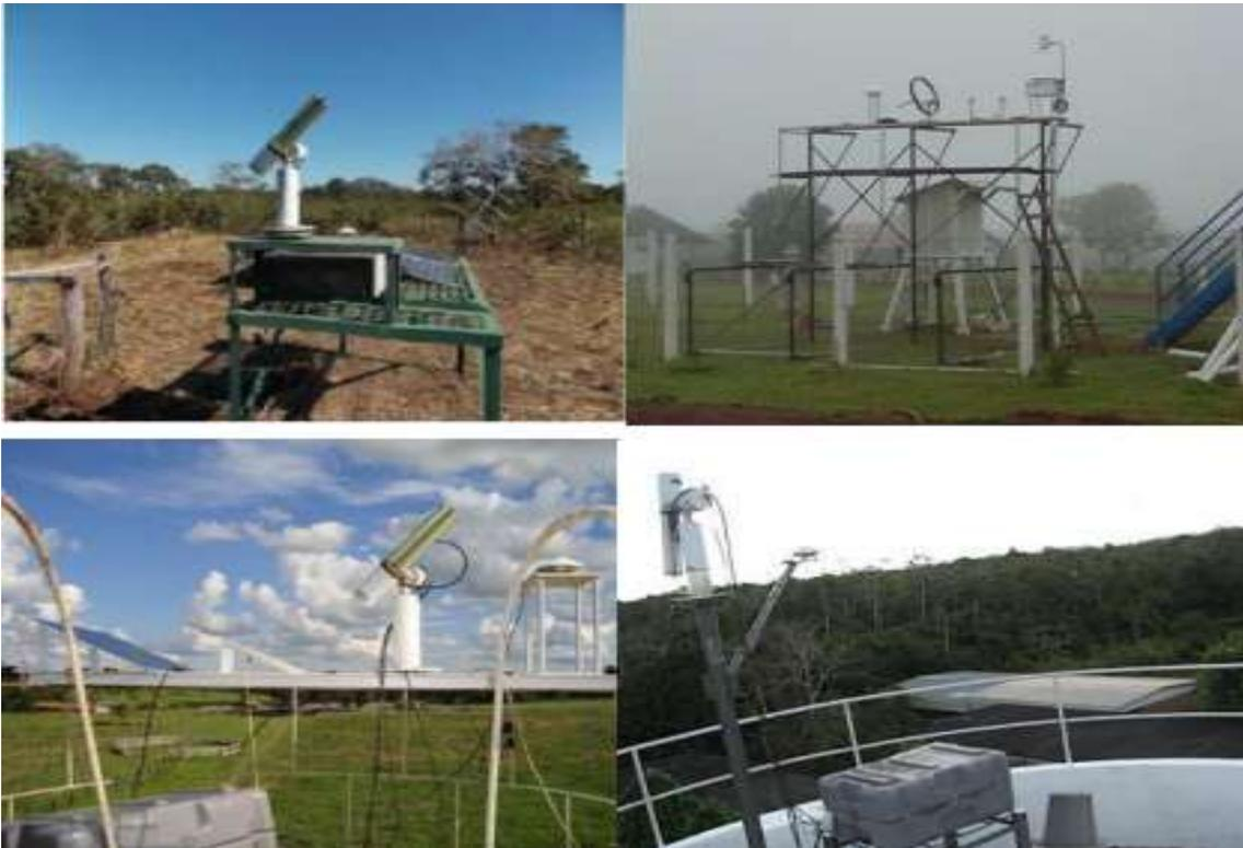
Figura 28. Fotômetros solares instalados em sítios de cerrado e floresta.
