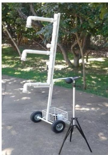
**FIGURA 20** - Medição de variáveis meteorológicas com o *Datalogger* e com Termômetro de Globo.
