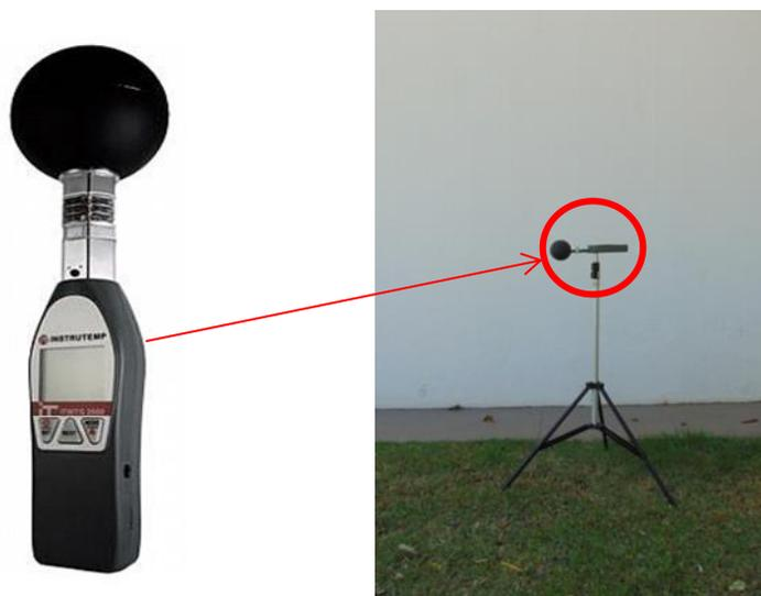
**FIGURA 12** - Termômetro de Globo ITWTG-2000
