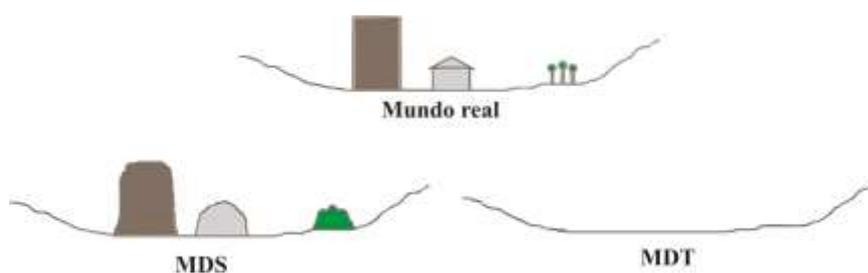
**Figura 20** -Tipos de modelagem de superfície
