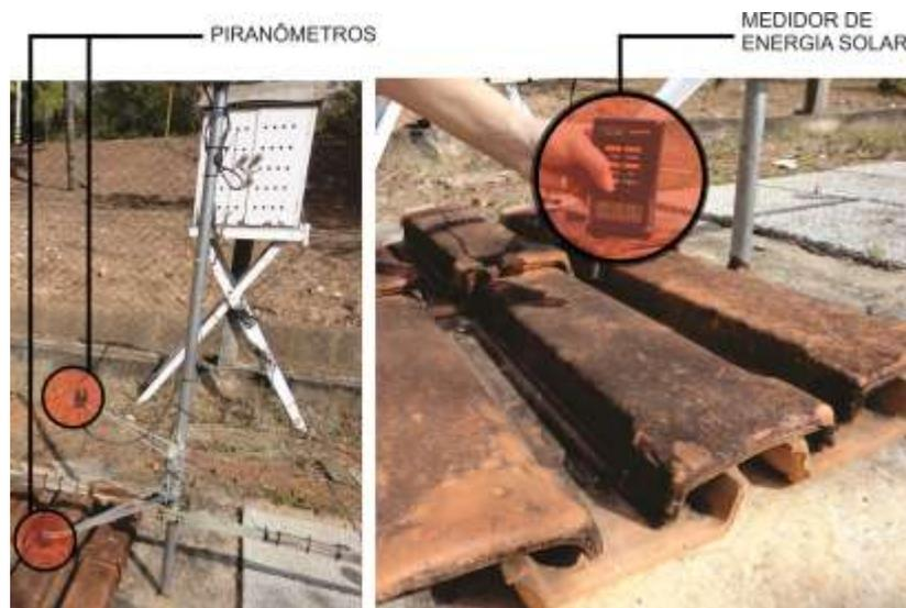
**Figura 47** - Sensores utilizados no experimento sobre as telhas
