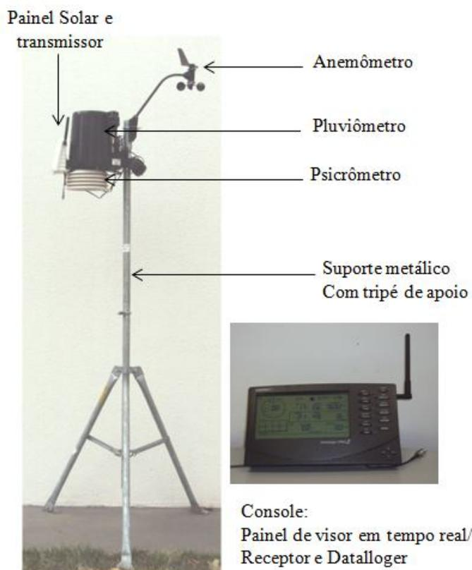
**Figura 16**-Estação micrometeorológica automática Vantage Pro 2 Plus (marca Davis Instruments)
