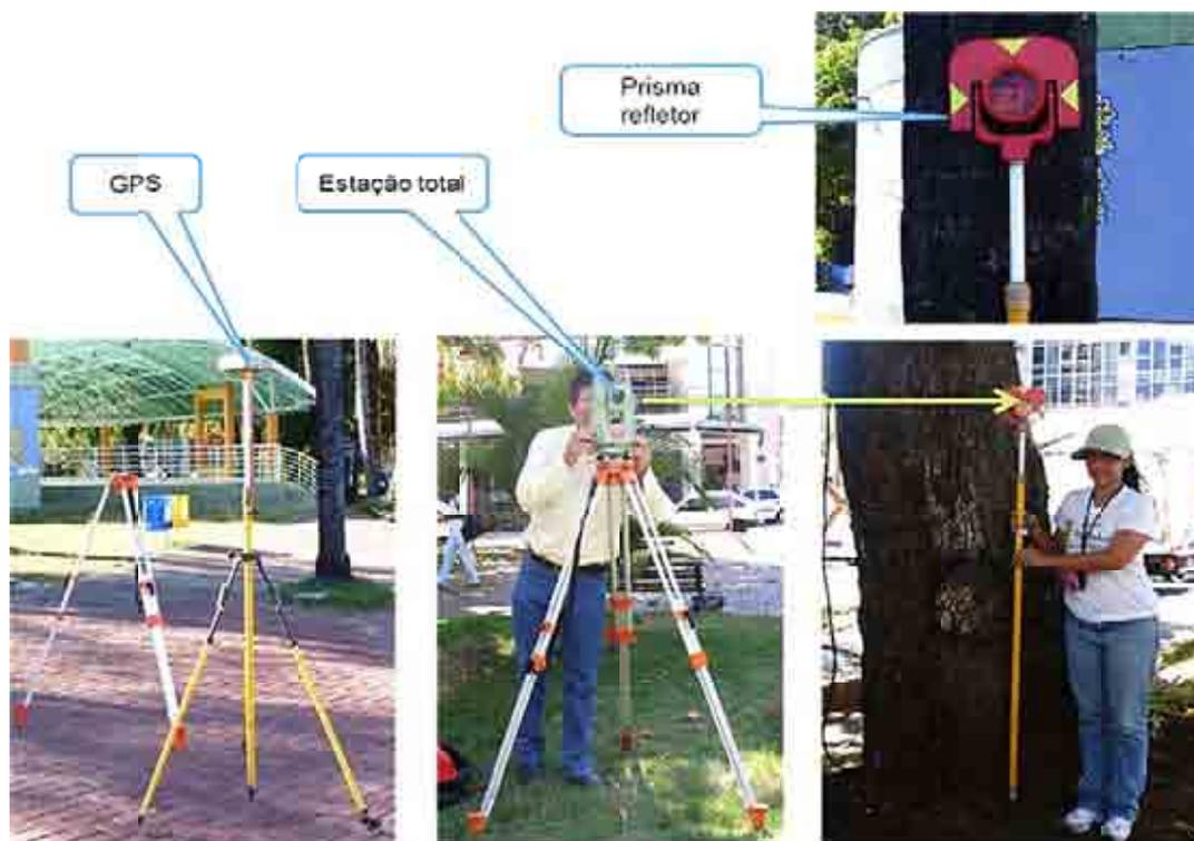
**Figura 25** – GPS, estação total e prisma refletor, utilizados para a localização dos indivíduos arbóreos
