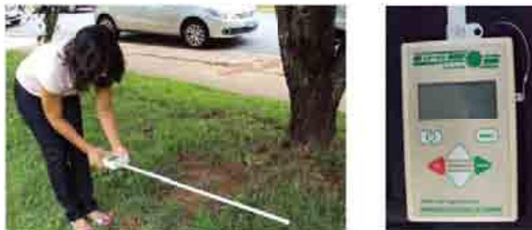
**Figura 29-** Ceptômetro AccuPAR Lp-80
