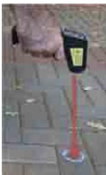
**Figura 22** - Termômetro digital infravermelho com mira laser (mod. TI-810)
