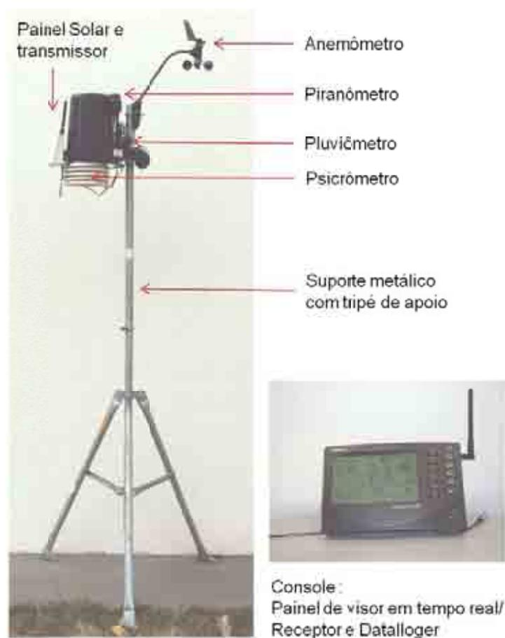
**Figura 18-** Estação micrometeorológica automática Vantage Pro 2 Plus (marca Davis Instruments)
