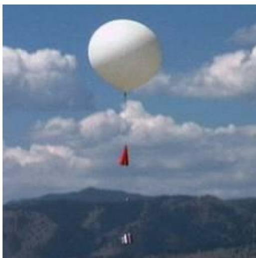
**Figura 11.** Balão meteorológico com sonda e paraquedas. Fonte: [atmos.millersville.edu](http://atmos.millersville.edu)
