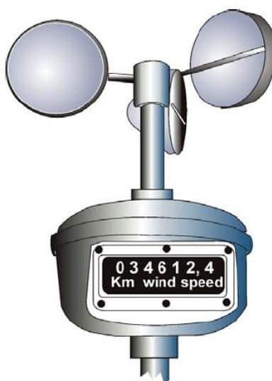
**Figura 06.** Anemômetro de Conchas. Os anemômetros de conchas com contador de voltas mecânico são chamados de totalizadores e fornecem leituras que possibilitam determinar apenas a velocidade média do vento em um dado intervalo de tempo. Possuem um conjunto de engrenagens que convertem o número de rotações do eixo em “distância percorrida” pelo vento, indicando-a digitalmente no visor. Fonte: Varejão- Silva, 2ª versão digital, 2006.
