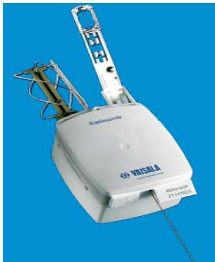
**Figura 10.** Radiossonda. Fonte: Varejão-Silva, 2ª versão digital, 2006.
