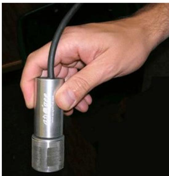
**Figura 7** - Sensor de  $O_2$  (modelo SO-110, Apogee Instruments, Logan, UT, USA).
