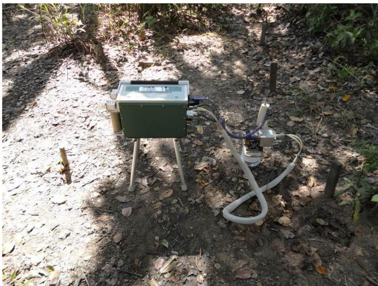
**Figura 3** - Aparelho de medida de efluxo de CO<sub>2</sub> do solo (modelo LI-6400 e câmara de fluxo modelo LI-6400-09, LI-COR, Lincoln, NE, USA).
