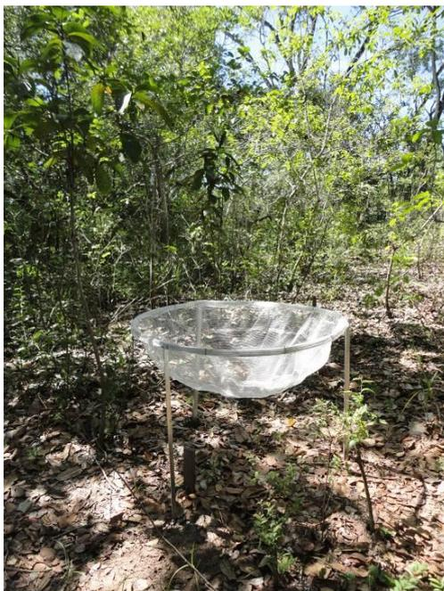
**Figura 9** - Armação de metal com tela de sombrite utilizada como coletor de serrapilheira.
