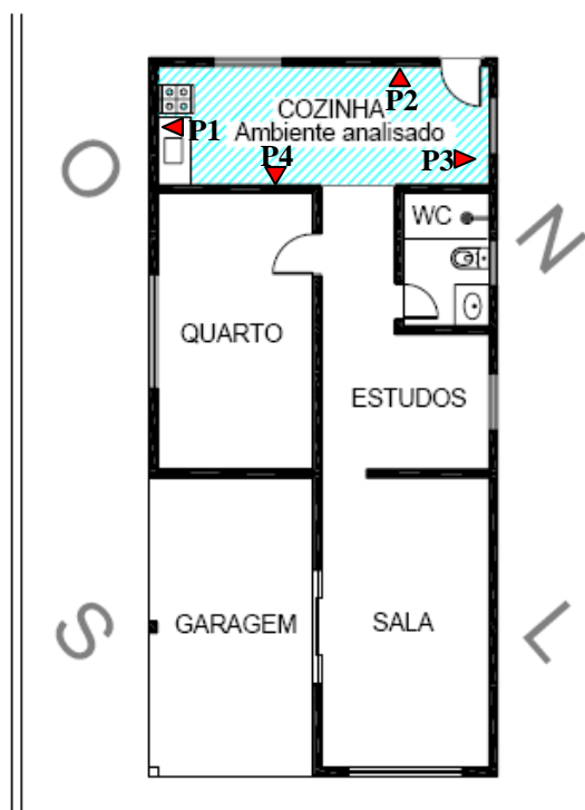
FIGURA 12 – Planta baixa da residência 02– P1: parede 1; P2: parede 2; P3: parede 3; P4: parede 4 FONTE: Oliveira (2007) modificado
