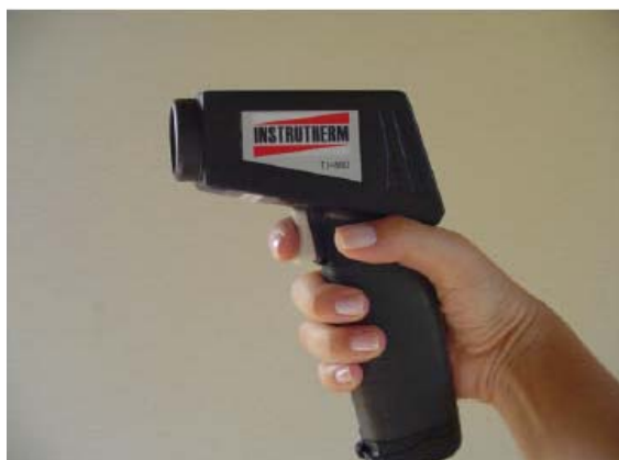
FIGURA 7 – Radiômetro infravermelho com mira laser digital portátil
