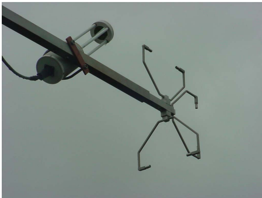
Figura 5. Conjunto anemômetro sônico e analisador.de gás (CO 2 e Vapor d'água) de circuito aberto NOAA-ATDD
