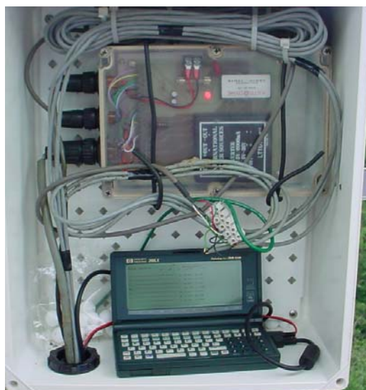
Figura 6. (a) Conjunto formado pelo Datalogger e módulo de memória, onde se destaca o cabo de conexão para transferência de dados a um computador portátil, (b) Palmtop para armazenar dados do anemômetro sônico e analisador de gás
