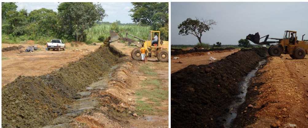
Ilustração 1. Viragem com pá-carregadeira (aeração) do conteúdo ruminal de bovinos no sistema de compostagem aeróbica.
