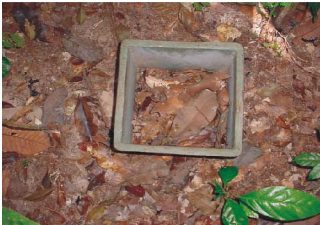
Figura 5 - Coletor em molde vazado de 0,25 m x 0,25 m utilizado para coleta de serrapilheira acumulada.
