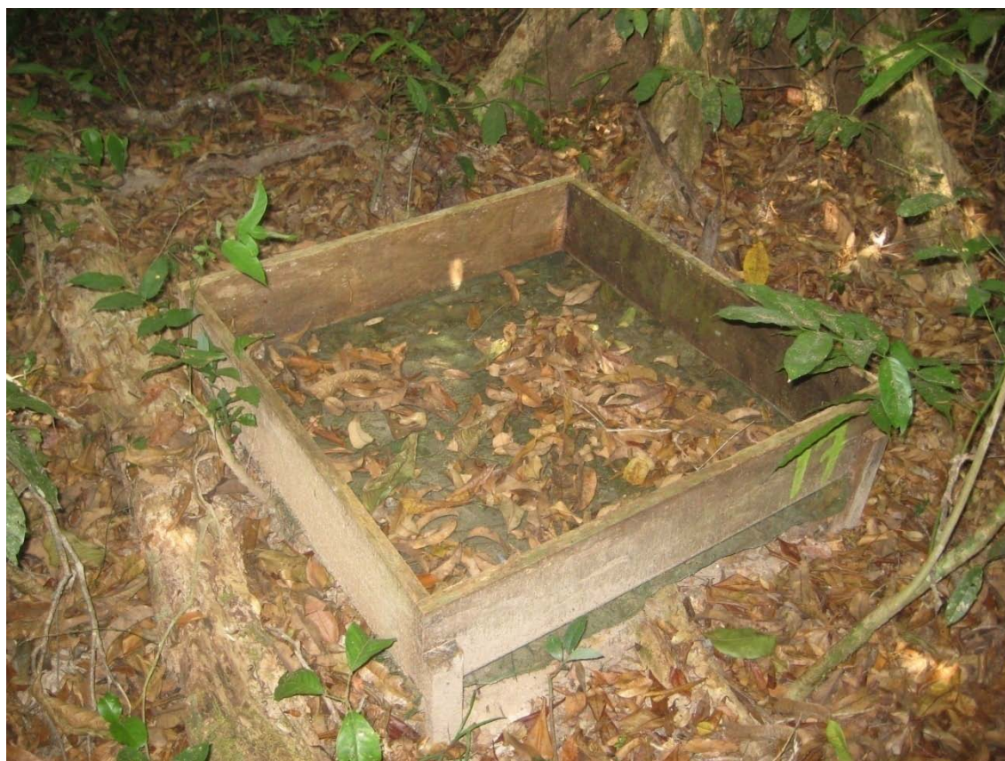
Figura 4 - Caixa coletora de serrapilheira de 1 m 2 utilizada para coleta de serrapilheira produzida.
