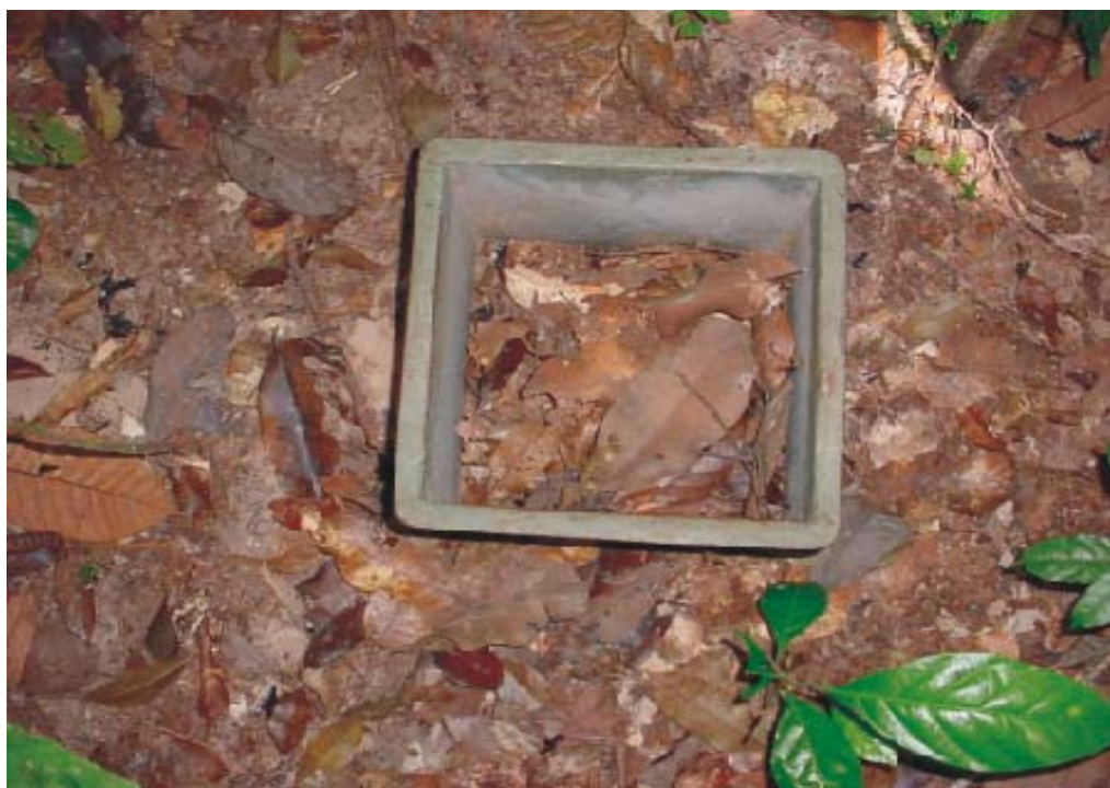
Figura 8 - Coletor em molde vazado de 0,25 m x 0,25 m utilizado para coleta de serrapilheira acumulada.
