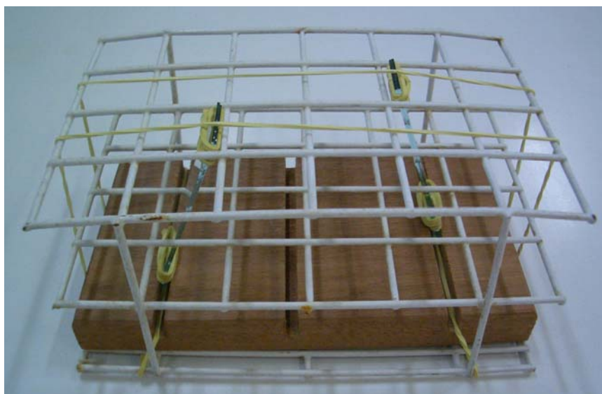
Figura 13 - Conjunto utilizado como substrato artificial para coleta das algas perifíticas.
