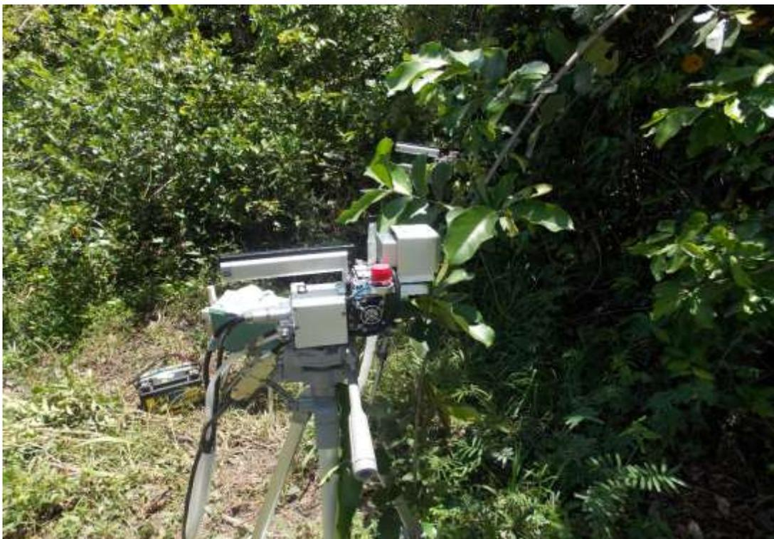
**Figura 14.** Cabeça sensora do LI-6400 (LI-COR, Inc., Lincoln, NE, USA) em operação.
