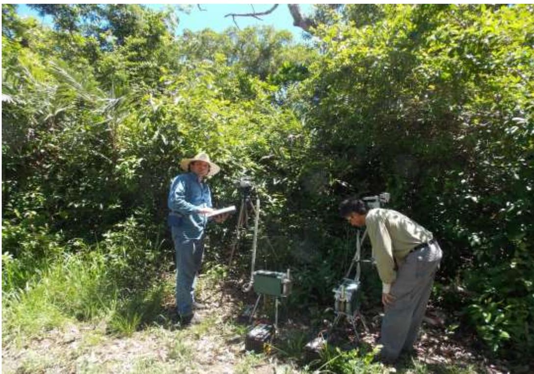
**Figura 13.** Medição em campo com LI-6400 (LI-COR, Inc., Lincoln, NE, USA).
