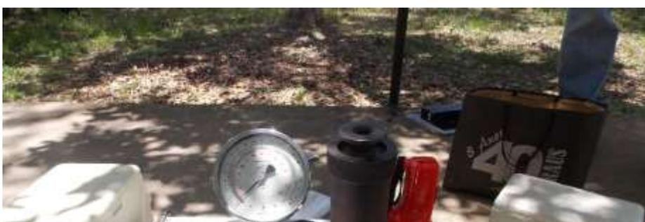
**Figura 11.** Bomba de Scholander, manômetro de resolução de 0,02 kgf/cm<sup>2</sup>
