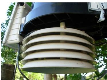
**Figura 10** - Discos de PVC da estação meteorológica comercial
