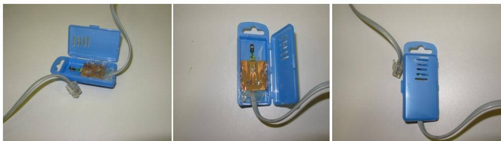
**Figura 8** - Acomodação do elemento sensor SHT75 em caixa ventilada (Neves, G.A.R., 2010)
