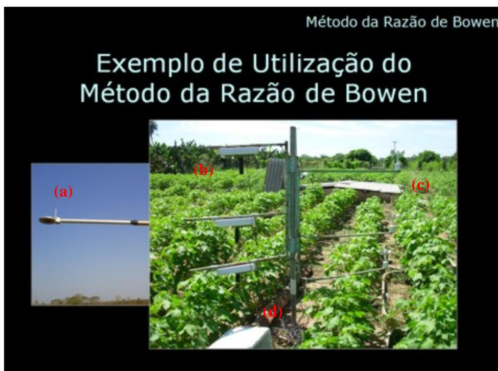
**Figura 33** – Slide norteador da discussão sobre os instrumentos utilizados no método da razão de Bowen. (a) Net radiômetro, (b) Psicrômetros, (c) Anemômetros e (d) fluxímetro.
