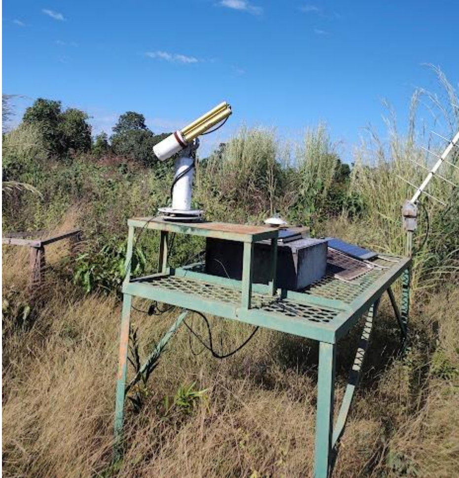
Figura 8 - Fotômetro do AERONET (Aerosol Robotic Network) instalado na Fazenda Miranda
