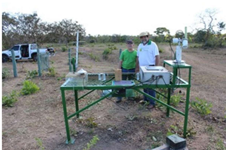
Figura 6 – Fotômetro CE318A no sítio CUIABÁ–MIRANDA. A esquerda responsável técnico e a direita pesquisador responsável.
