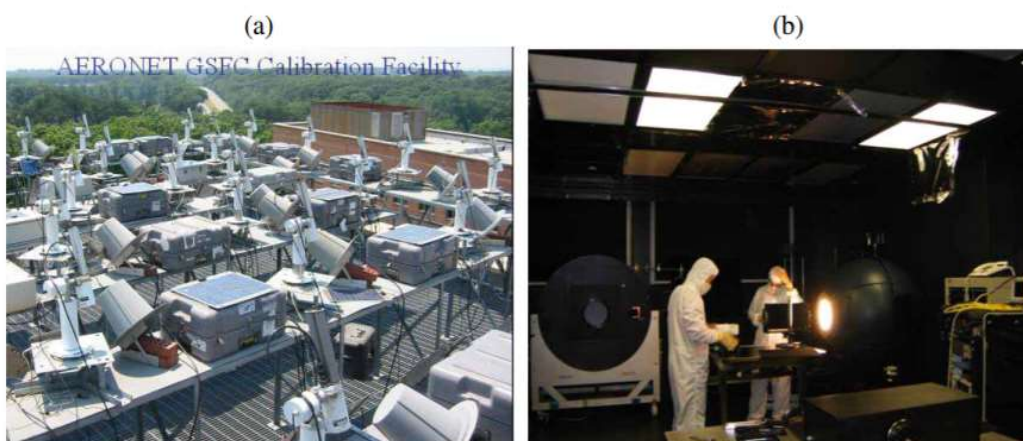
Figura 8 – Calibração do fotômetro CE318A nos laboratórios da NASA. a) Calibração do sensor de radiância direta a partir de instrumentos de referência calibrados em Mauna Loa, Hawai. b) Calibração do sensor da radiância do céu por meio de uma esfera integradora.
