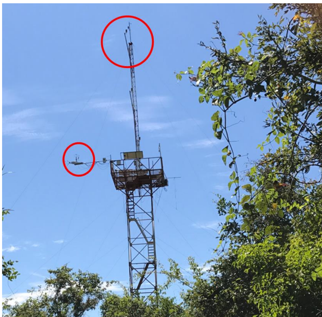
FIGURA 16: Torre de Fluxo BR-NPW. Bahia das Pedras – SESC Pantanal. Círculos vermelhos indicam os instrumentos micrometeorológicos.
