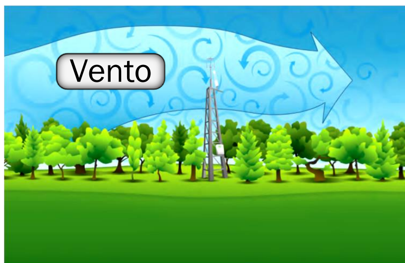
Figura 16: Fluxo de ar representado por uma grande flecha que passa através da torre, e consiste de redemoinhos de tamanhos diferentes.
