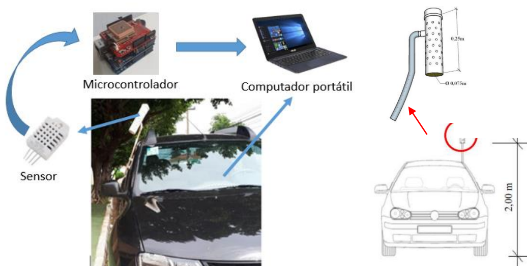
Figura 28 – Instrumentos utilizados na coleta de dados climáticos em transecto móvel
