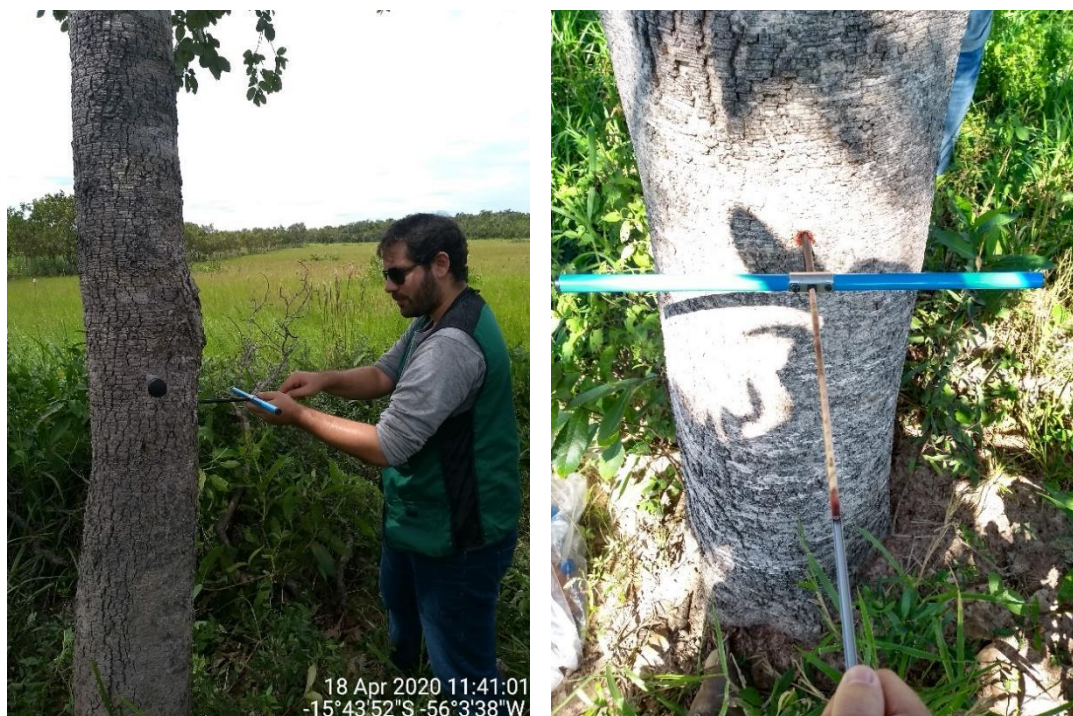
FIGURA 1.7 - Amostragem não-destrutiva: extração de amostra de xilema de Hymenaea stigonocarpa Mart. ex Hayne com sonda de Pressler.
