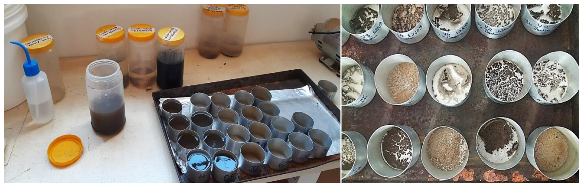
Figura 34. Separação e secagem de sedimentos de arrasto.
