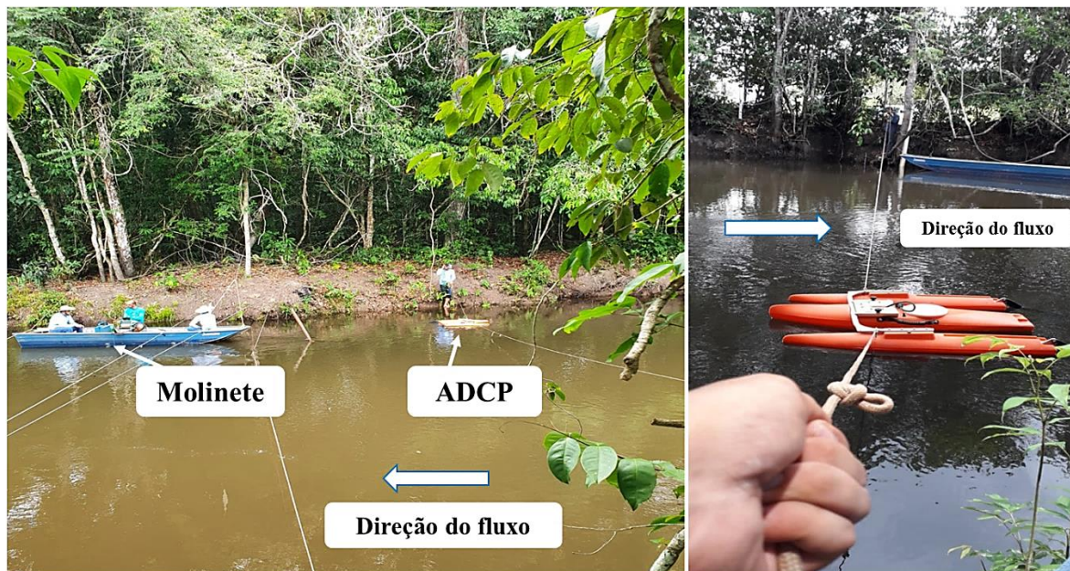
Figura 16. Medida da vazão líquida com molinete hidrométrico e ADCP em seções transversais hidrológicas paralelas.
