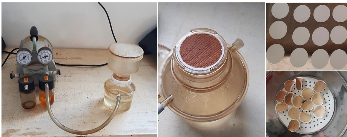
Figura 33. Sistema de filtragem de sedimentos em suspensão.
