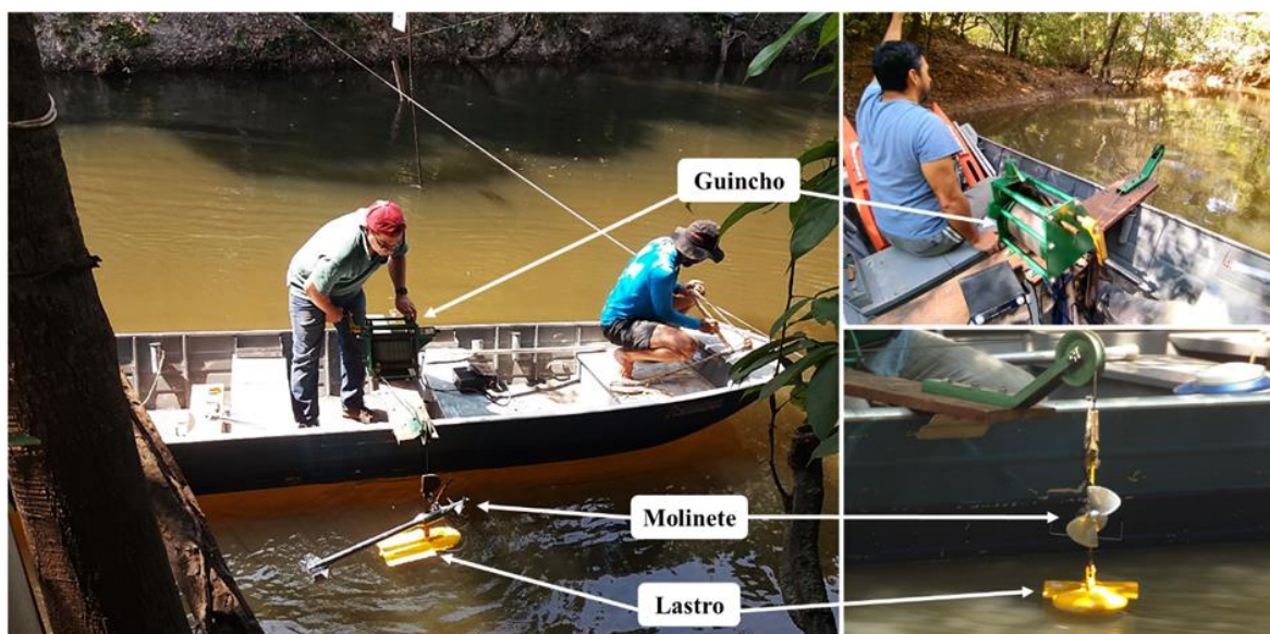
Figura 3. Medição de vazão líquida em embarcação com molinete hidrométrico MLN-7 acoplado ao guincho fluviométrico.
