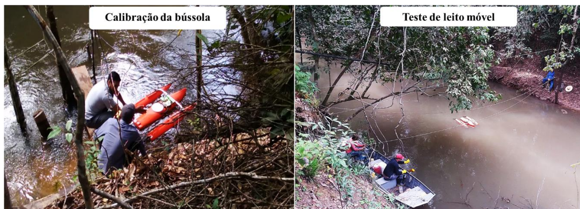
Figura 15. Calibração da bússola e teste de leito móvel estacionário com o ADCP RiverRay.
