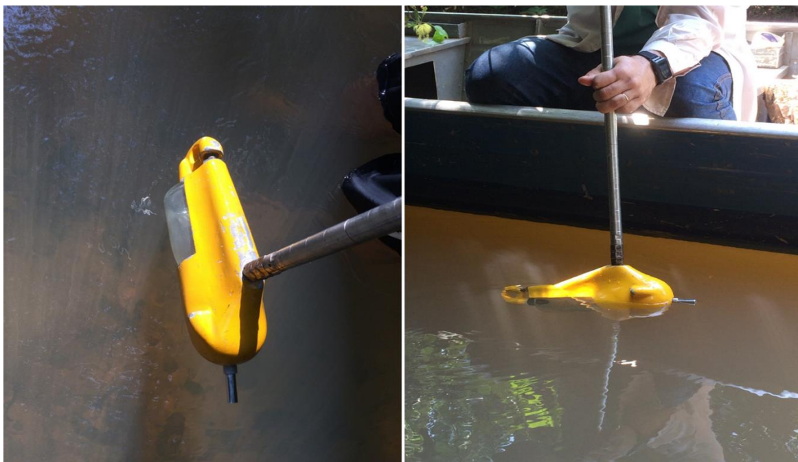
Figura 29. Amostrador de sedimentos em suspensão US DH-48 amostragem a vau.
