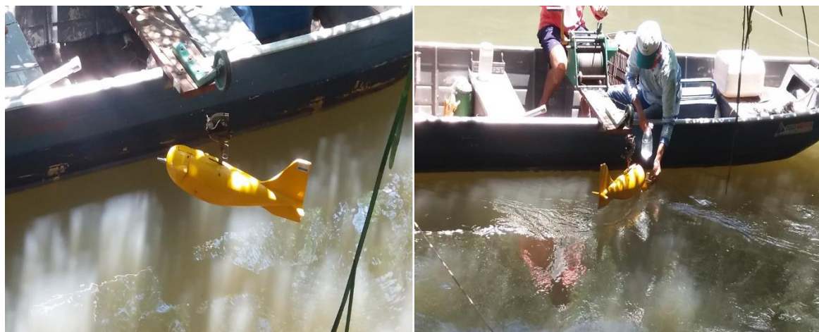
Figura 30. Amostrador de sedimentos em suspensão US D-49 acoplado no guincho fluviométrico.
