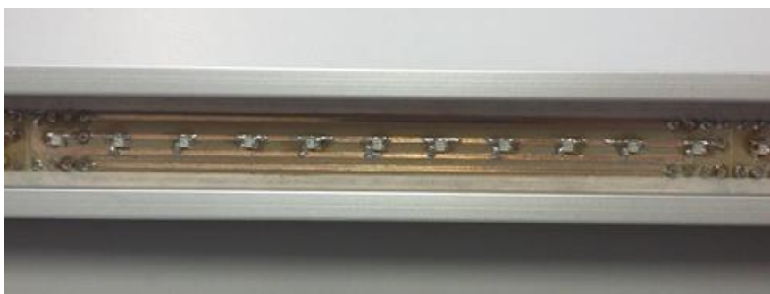
Figura 18. Segmento da sonda constituído por LEDs RGB.
