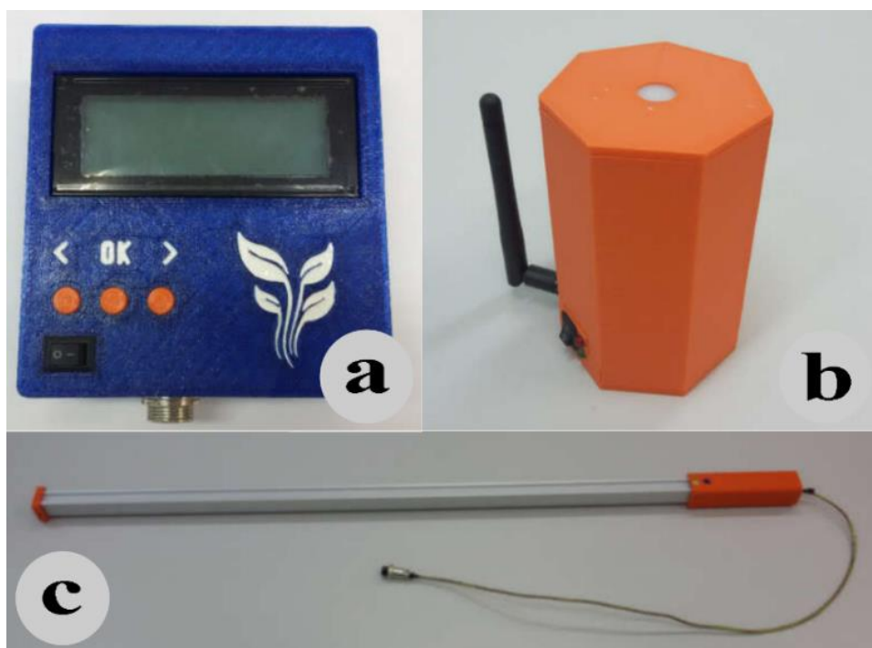
Figura 4. e-Quantum 85, protótipo alternativo inicialmente desenvolvido para obtenção do IAF, onde: (a) unidade de controle, (b) sonda e (c) sensor de incidência.
