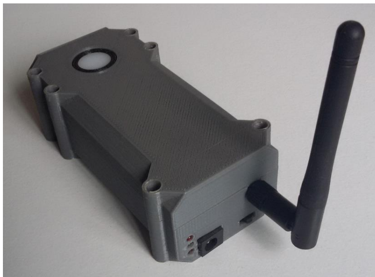
Figura 21. Aspecto final da montagem do sensor de incidência.
