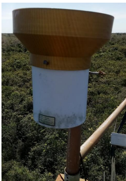
FIGURA 08 – Pluviometro do tipo TE525MM-L instalado na torre micrometeorologica do pantanal
