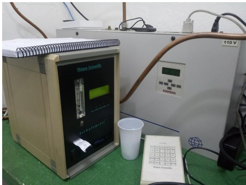
FIGURA 11 - Aethalometro modelo AE42, a esquerda. Nefelometro Aurora 1000, a direita.
