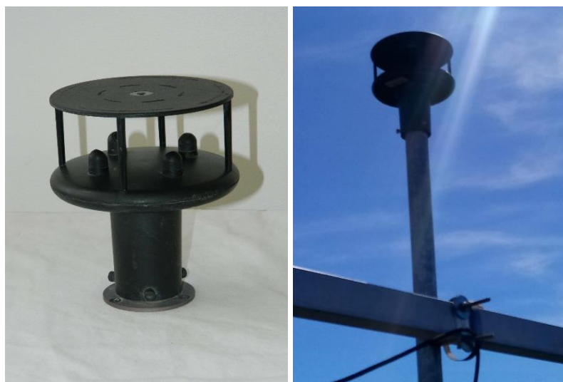
FIGURA 07 - Anemometro 2D Ultrasonico, visão do sensor à esquerda e sensor instalado na torre, a direita. GILL INSTRUMENTS, 2015
