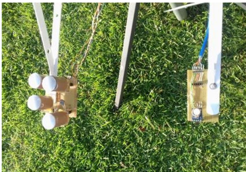
**Figura 31.** Calibração dos sensores LEDs e TSL 2561 (Autor).
