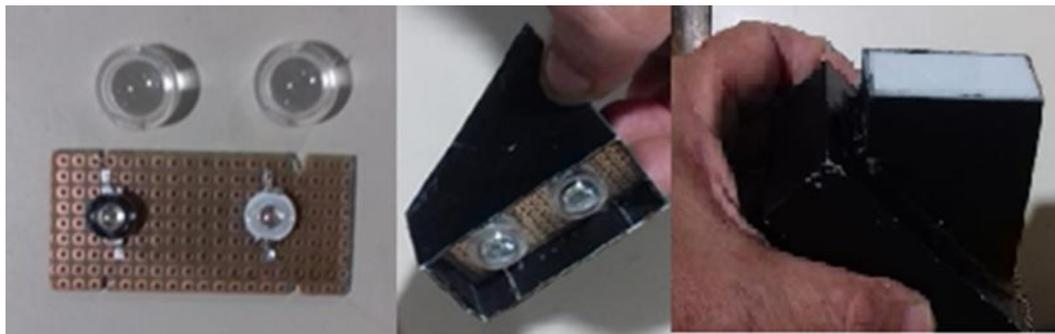
**Figura 26.** Montagem dos LEDs, colimadores e difusor. (Autor)
