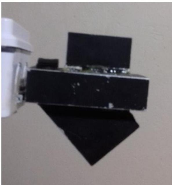
**Figura 39.** Sonda intercambiável (Autor).
