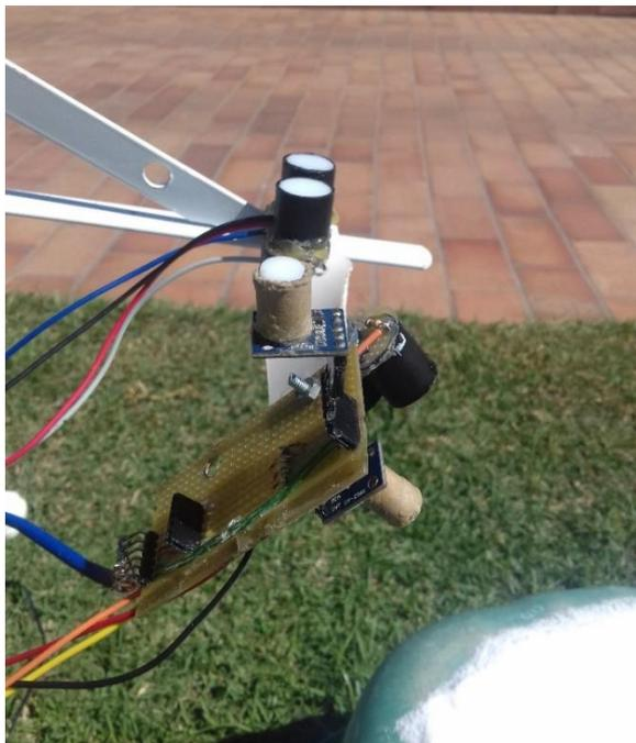
**Figura 32** Disposição dos sensores para tomada de medidas de NDVI (Autor).
