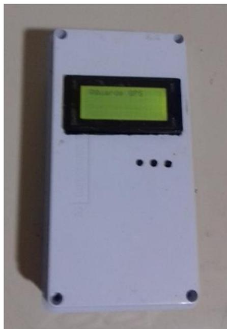
**Figura 40.** Medidor portátil de NDVI (Autor).
