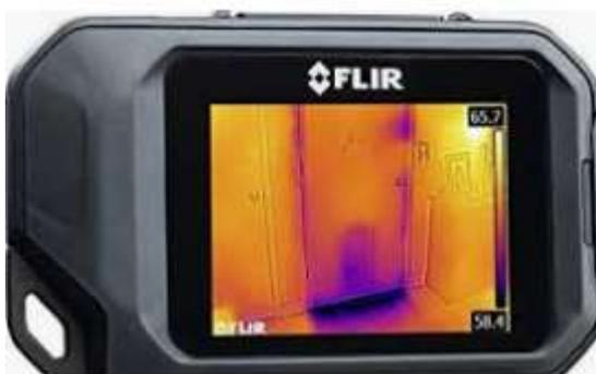
**Figura 16:** Câmera digital termográfica
