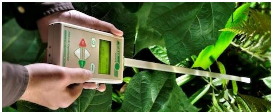
**Figura 9.** Medidor Ceptometer Accupar modelo LP80
