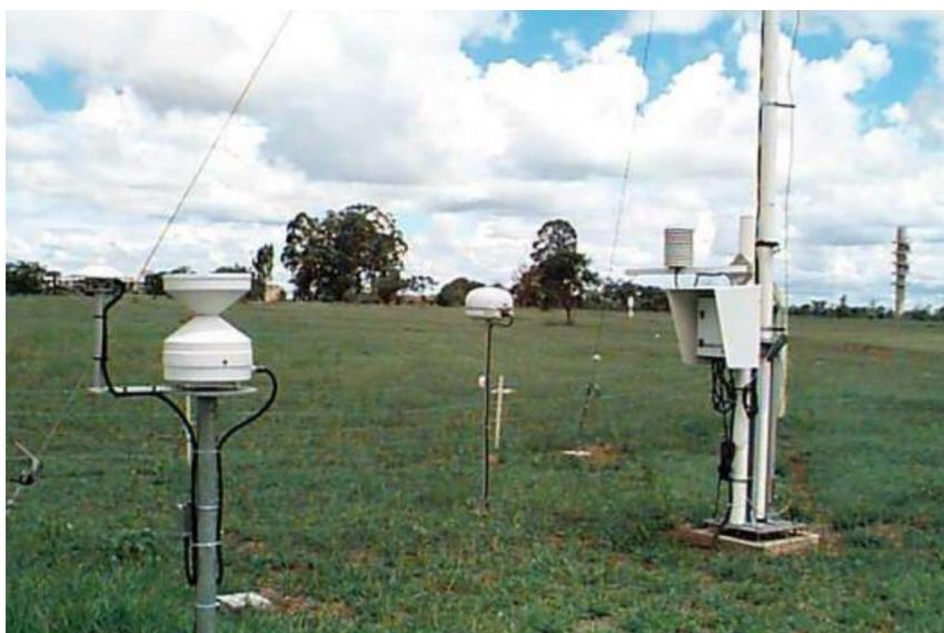
**Figura 5: Pluviômetro, ao centro a antena de comunicação via satélite e à direita o datalogger com sensor de temperatura presos ao mastro. Fonte: INMET, 2018.**
