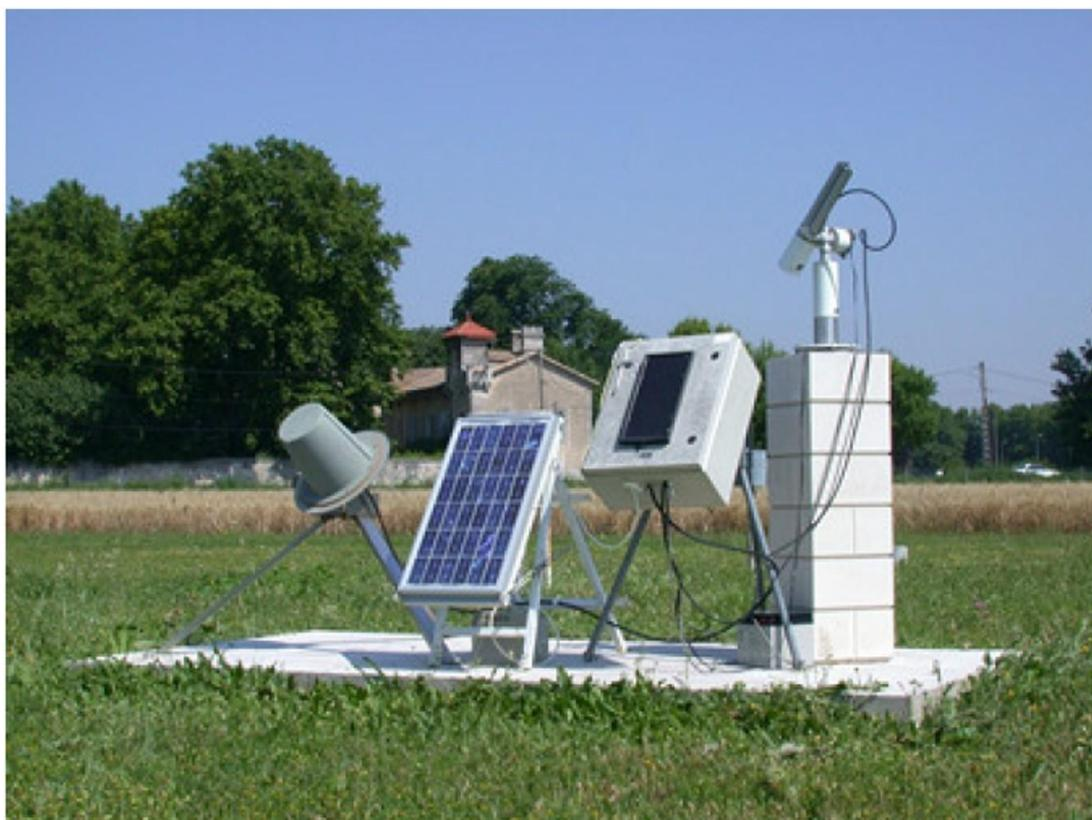
**Figura 17.** Instrumentação da rede AERONET, radiômetro solar CIMEL 318A, antena de transmissão de dados e o painel solar (Extraído de Sena, 2013).
