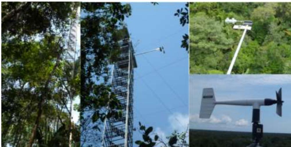
**Figura 3.5** – Instrumentação da torre acima do dossel, com pirômetros e anemômetro.
