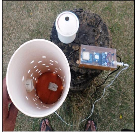
Figura 6: Abrigo termométrico
