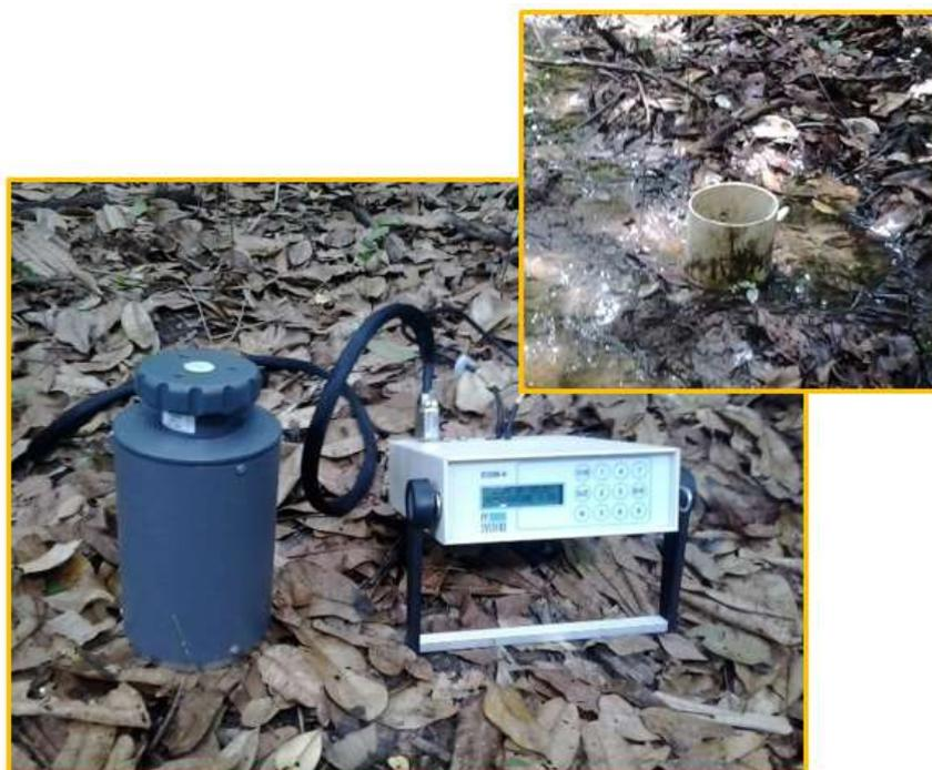
**Figura 8.** Analisador de gás por infravermelho portátil (modelo EGM-4, PP Systems, UK) com câmara de fluxo de CO<sub>2</sub> do solo (modelo SRC-1, PP Systems, UK) e canos de PVC instalados em cada ponto para as medidas de efluxo CO<sub>2</sub> do solo.
