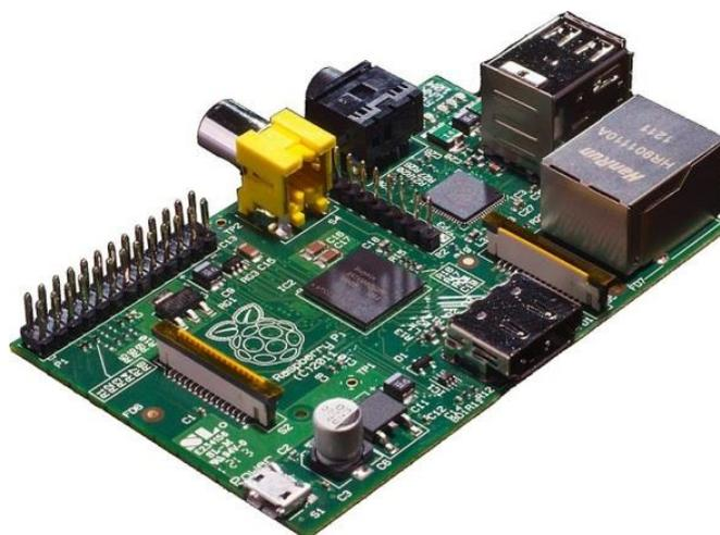
**Figura 08** – Placa do Raspberry Pi – Modelo B.
