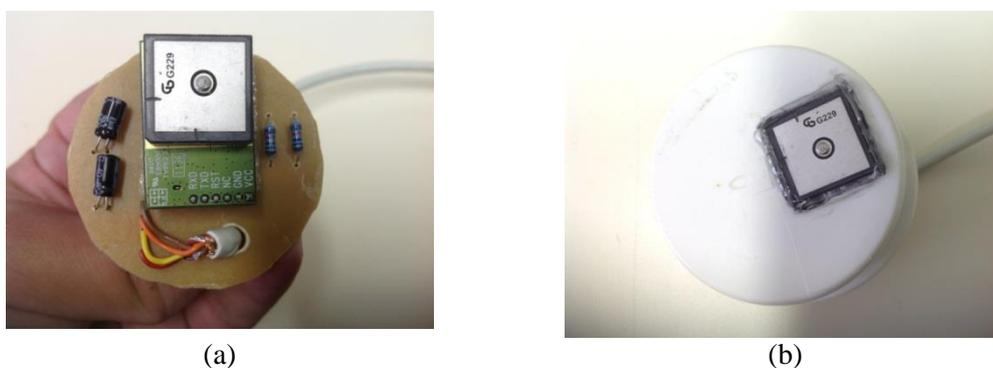
**Figura 45** – Suporte ao módulo do GPS: (a) Placa de suporte, (b) Abrigo do GPS.
