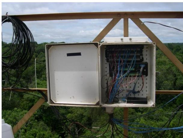
**Figura 15-** Conjunto formado pelo Datalogger e módulo de memória, onde se armazenam dados do anemômetro sônico e analisador de gás
