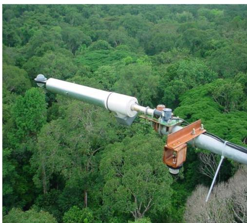
**Figura 16-** Net radiômetro instalado acima da copa das árvores
