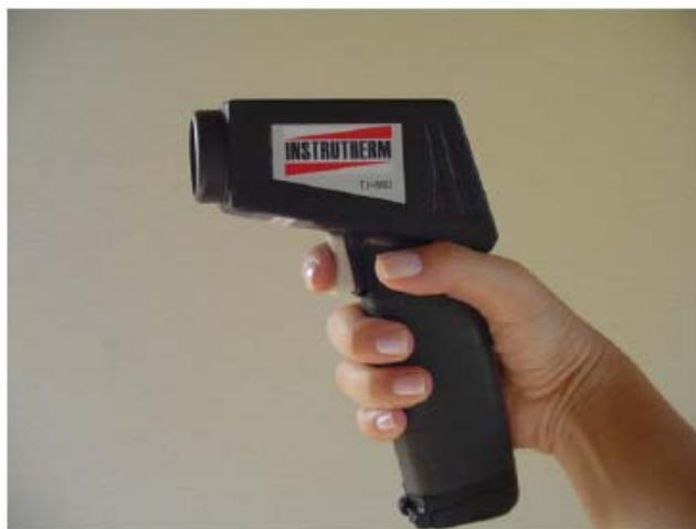
**FIGURA 12** - Radiômetro infravermelho com mira laser digital portátil
