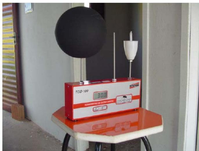
**FIGURA 11** - Termômetro de Globo Digital da marca Instrutherm
