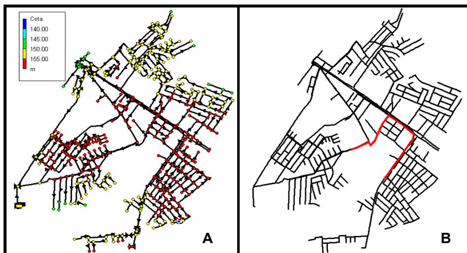
Figura 74 – Cotas altimétricas do sistema (A) e trajetória atual da água (B) quando é direcionada ao bairro Nossa S. Aparecida (forma de U)
