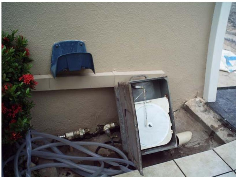
**Figura 19 - Registrador para Medição de Pressão em cavalete**
