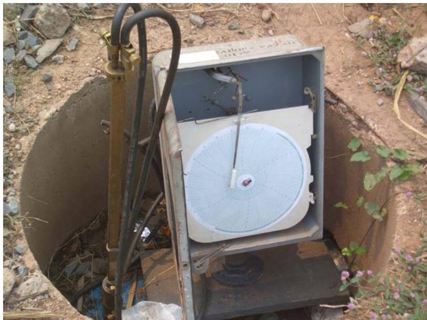
Figura 15 - Medidor de Vazão da Saída das Bombas
