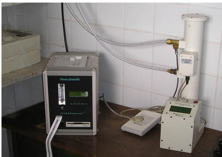
Figura 11 – Foto de ilustração do Aetalômetro compacto Magee AE-31 (método de absorção) para monitoramento contínuo de carbono elementar (*Black Carbon* – BC) e o monitoramento de diferentes aerossóis.
