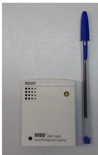
**Figura 13** - Sensor datalogger - Modelo Hobo
