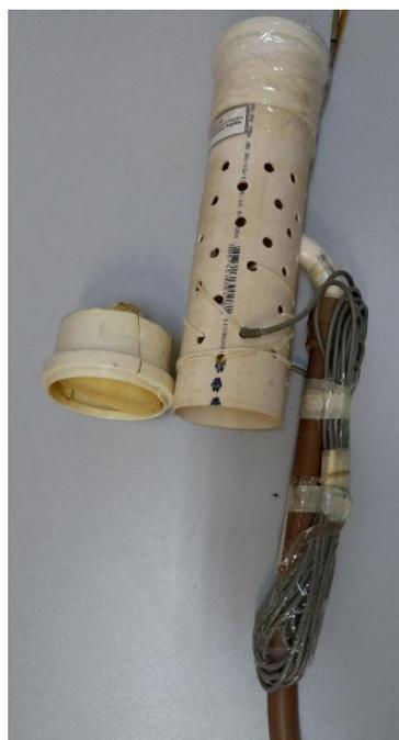
**Figura 14** - Abrigo para o datalogger Hobo
