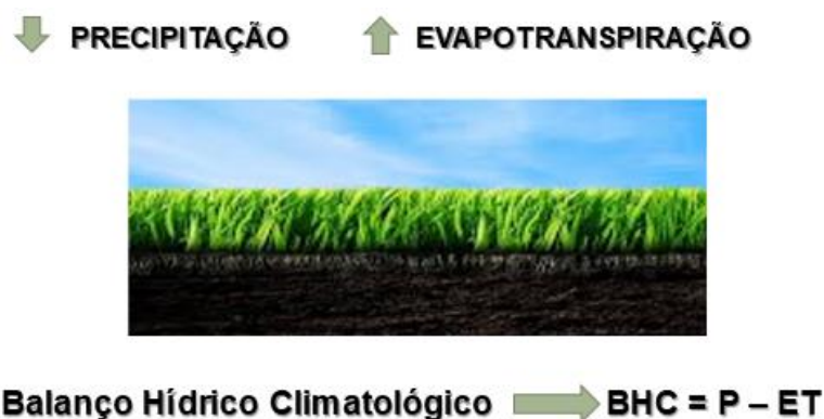
Figura 4 - Fluxos de entrada (precipitação) e saída (evapotranspiração) de água no Balanço Hídrico.
