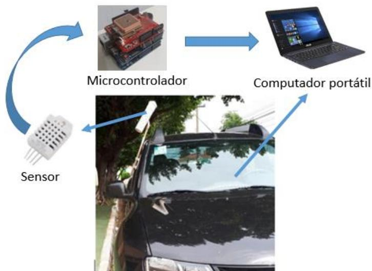
**Figura 26** - Adaptação do sensor para transecto móvel.
