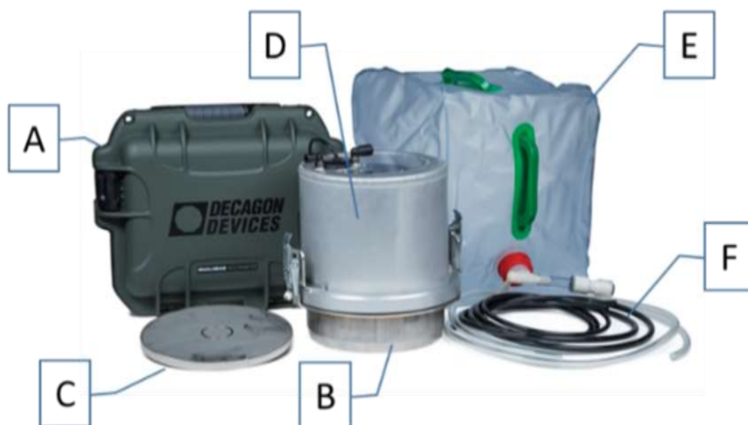
FIGURA 2 – Infiltrômetro de pressão dupla carga e componentes. A: Unidade de controle, B: Anel de inserção, C: prato de condução, D: parte superior do infiltrômetro que se encaixa ao anel de inserção, E: reservatório de água dobrável e F: tubos de conexão entre infiltrômetro, reservatório de água dobrável e unidade de controle.
