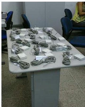
Figura 30 - Aferição dos sensores dataloggers
