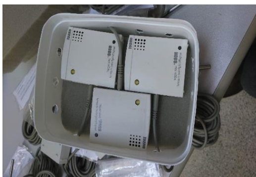
Figura 24 - Sensor datalogger no abrigo pote de sorvete
