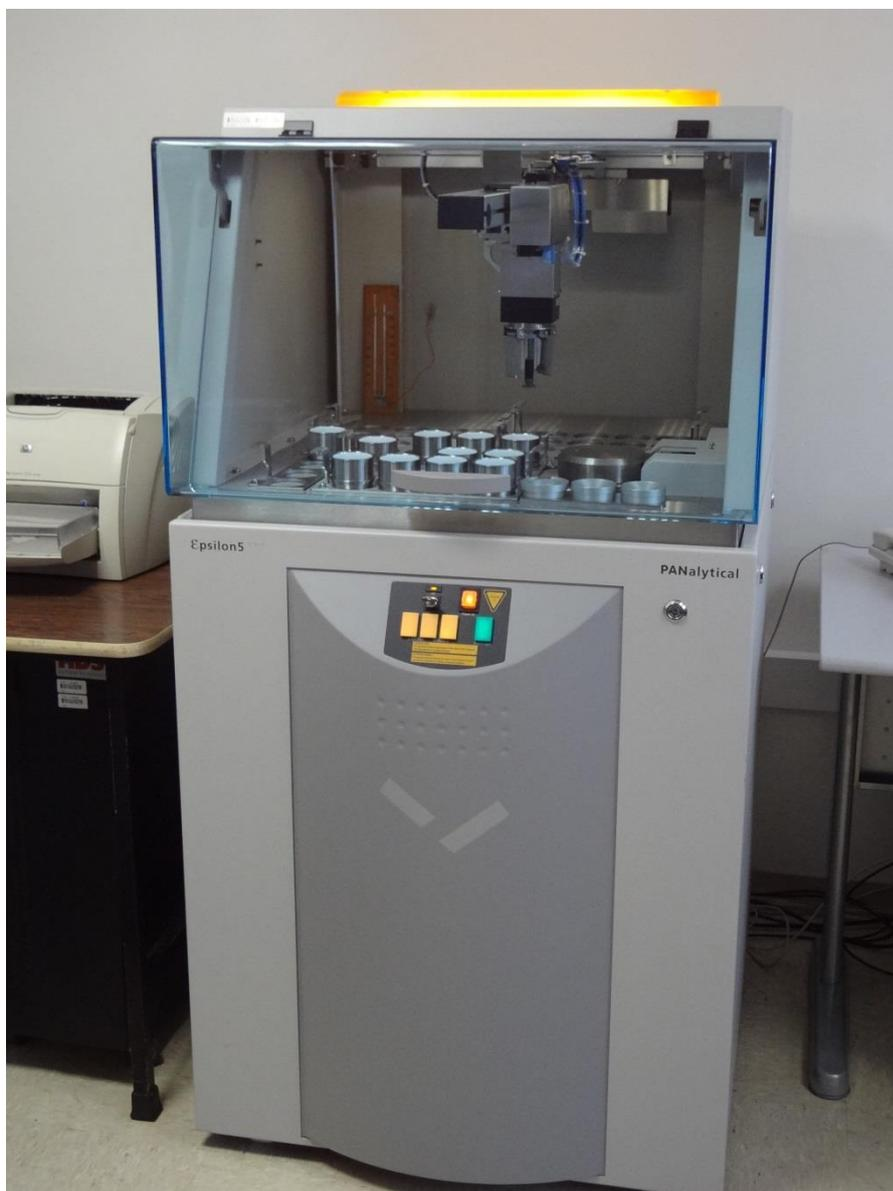
**Figura 10.** Aparelho utilizado para quantificação elementar das amostras utilizando indução por Raios-X.
