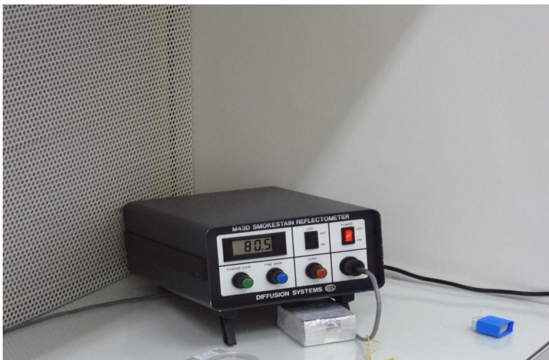
**Figura 9.** Refletômetro usado para a quantificação do BC.
