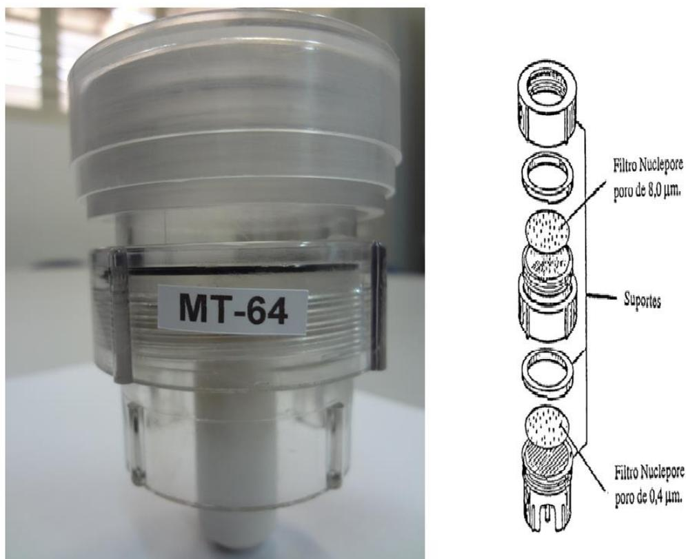
**Figura 6.** Amostrador de particulado fino e grosso (AFG). (PARKER et al., 1997; JOHN et al., 1983).
