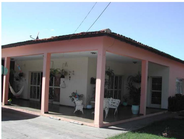
**Figura 15** - Edificação composta por painéis verticais com enchimento em tijolos cerâmicos de oito furos, edificação “2”.
