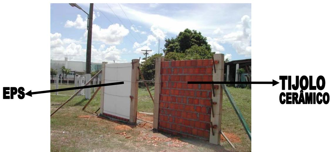
**Figura 20** - Painéis com os materiais expostos.
