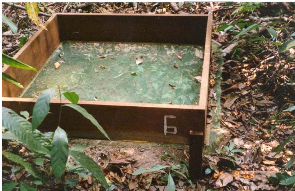
Figura 3.5. Caixa coletora de serrapilheira.
