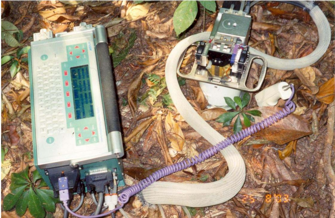
Figura 3.6. Aparelho de absorção de CO<sub>2</sub> por gás infravermelho (LI-6400) acoplado à câmara de retenção de CO<sub>2</sub> (LI-6400-09) e sensor de temperatura (LI-6000-09TC).
