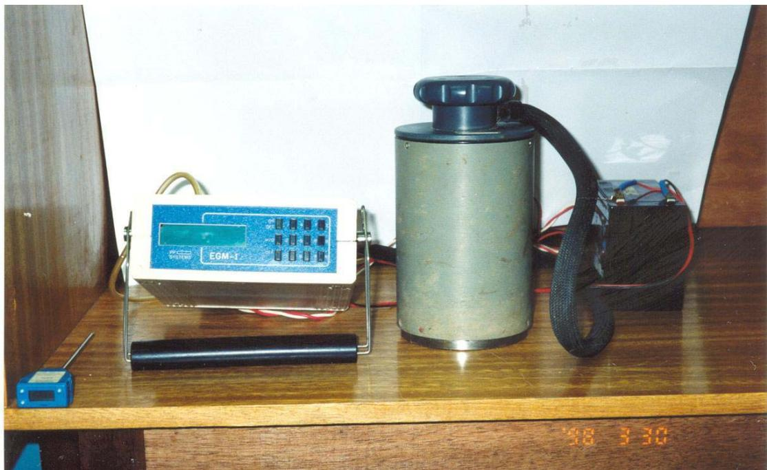
Figura 3.7. Aparelho portátil de absorção de CO<sub>2</sub> por infravermelho (EGM-1/WMA-2) e termômetro digital.
